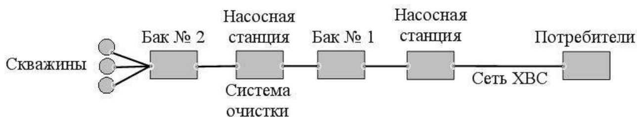
Рис. 1.2. Принципиальная схема системы ХВС «ВНС-II»
