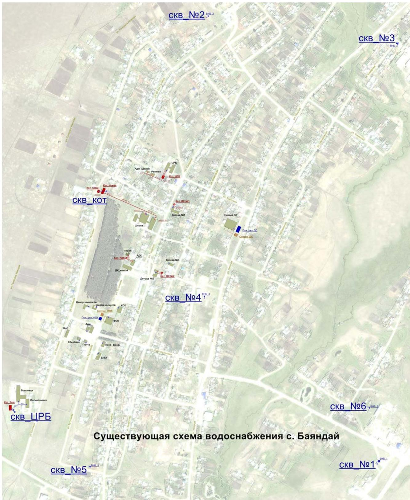
**Рис. 1.1. Общая схема водоснабжения с. Баяндай**
